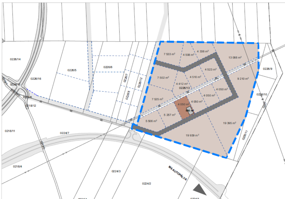
41. ábra: Villányi iparterület I. ütemének tervezett telekkialakítás
